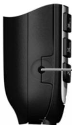
Vous pouvez raccorder un kit oreillette à l'aide d'une prise de 2,5 mm. Des recommandations sur les kits oreillette sont disponibles sur la page relative à l'appareil sur [www.gigaset.com](http://www.gigaset.com).
